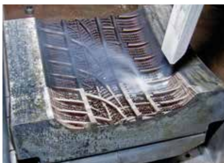
Formenreinigung mit Trockeneis
